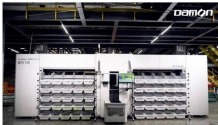
图表58:德马科技智能播种机器人缩减二次分拣人工作业
