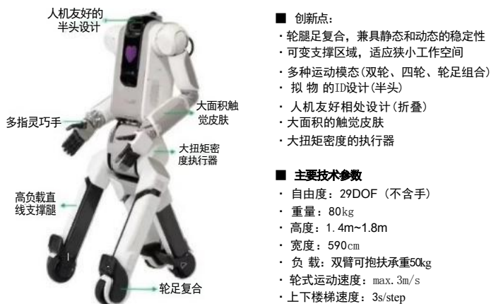
图表45: 康养场景预计先用轮式机器人进行过渡后续迭代为双足机器人
